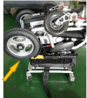
A4. Coloque la silla de ruedas sobre el tablero en posición invertida como se muestra en la imagen, con las ruedas en contacto con el borde del tablero.
