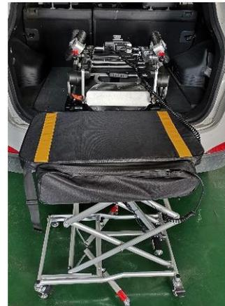
B5. Ajuste la posición de la plataforma de tal forma que el tablero quede 50mm por encima de la altura del maletero. Alinee las dos líneas rojas de la plataforma con las ruedas de la silla.
