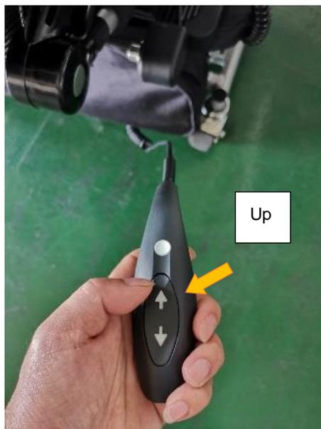
A6. Mantenga pulsado el botón "Arriba" del mando hasta que el tablero llegue a la altura de la superficie inferior del maletero del vehículo.
