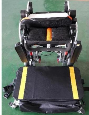
B13. Levante un extremo de la silla, pose las ruedas motrices de la silla sobre el suelo y separe la silla de la plataforma.
