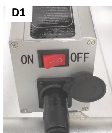
3. Para evitar que la clavija de alimentación se suelte durante el uso, fije la cintay asegúrese de que la clavija de alimentación quede firmemente insertada. Encienda el interruptor de alimentación.
