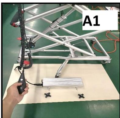
1. Para empezar a instalar la batería, conecte la clavija de alimentación de la plataforma a la batería, y pulse el botón “Arriba” del mando de control a fin de elevarla plataforma unos 50 cm (como se muestra en la figura).
