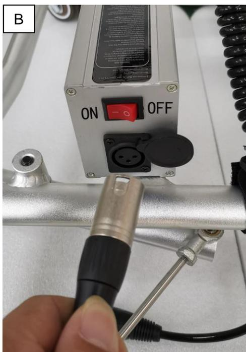
3. Si la batería está montada en la plataforma, solo tendrá que soltar la clavija de alimentación e insertar la clavija del cargador para cargar la batería.
