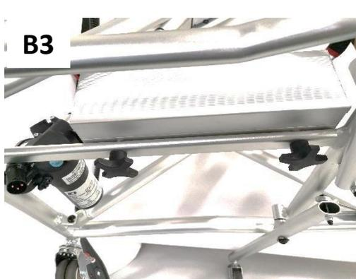
2. Inserte los dos tornillos de la batería en los agujeros correspondientes del bastidor y apriete el pomo. Asegúrese de que la batería esté instalada en la misma dirección que se muestra en la Figura B.
