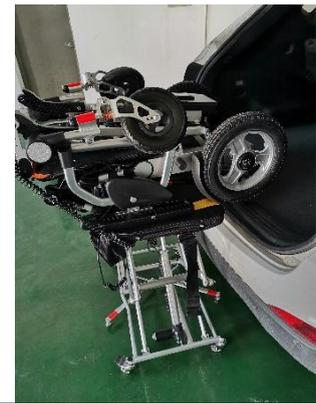
B8. Las ruedas de la silla deben estar en contacto con el borde del tablero, como se muestra en la imagen, para garantizar que la silla de ruedas esté colocada de forma estable.
