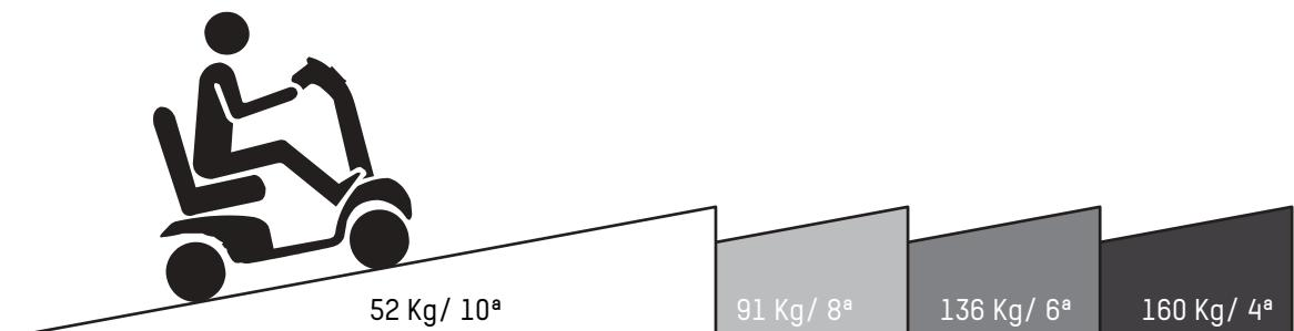
El grado de inclinación se ve afectado por la capacidad de peso, velocidad, pendiente, y parámetros del scooter.
