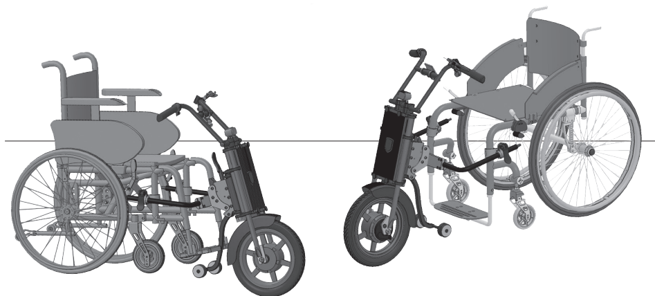
Figura 1. El dispositivo UNAwheel Maxi está acoplado a una silla de ruedas con soportes abatibles para las piernas (a la izquierda) y a una silla de ruedas de chasis rígido (a la derecha)
