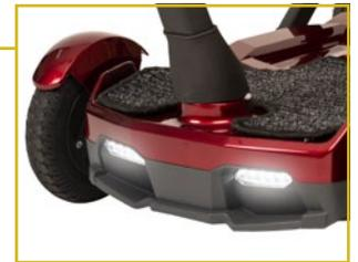
Luces LED delanteras y traseras
