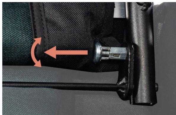
Desbloquee el mecanismo de fijación del respaldo
