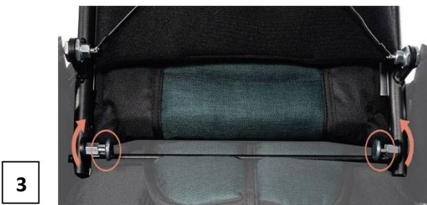
Mecanismo desbloqueado a la altura de los orificios en ambos lados
