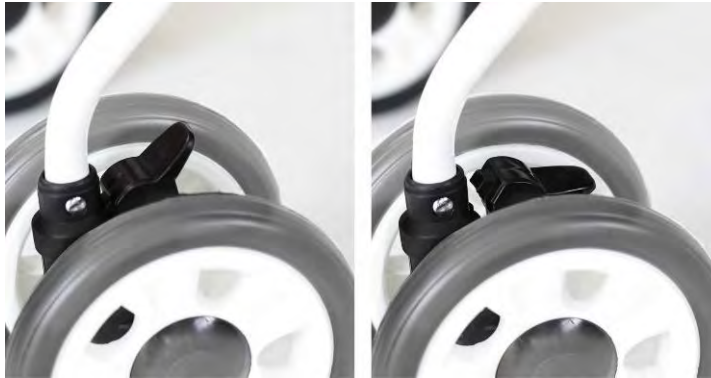
Foto 9.3.1 Bloqueo de las ruedas activado
