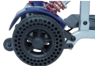
Rueda trasera macizo Honeycomb de 7 pulgadas
