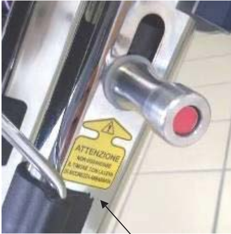
Atención: No enganchar el timón con la palanca de seguridad abajo
