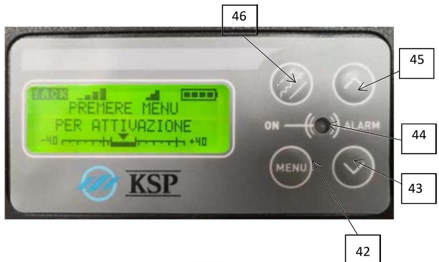
En la pantalla, arriba a la derecha, hay un icono de batería (51) que indica el estado de carga. En la parte de abajo de la pantalla, hay una escala graduada (49) y un cursor móvil (50) que indican la inclinación del recorrido.
