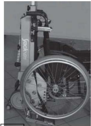
Asegúrese de que la silla de ruedas quede centrada con respecto al salvaescaleras y apriete los dos volantes (18) para fijar el bastidor de la silla de ruedas a la abrazadera (17).
