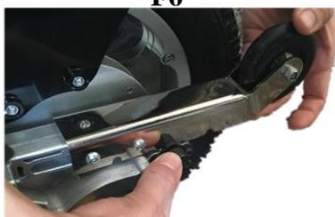
7. Como se indica en la Fig. F7 pulsar el botón anti-vuelco y sacar la rueda anti-vuelco.
