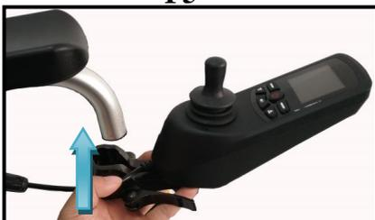
6. Montar el panel de control y conectar el cable de 4 clavijas según la Fig. F6. (consultar las instrucciones sobre montaje del panel de control)
