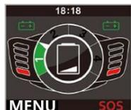
2, Cuando la potencia es menor del 10%, el indicador de batería está en rojo e indica que no se puede avanzar, la potencia es demasiado baja y que la silla se parará automáticamente en pocos minutos.
