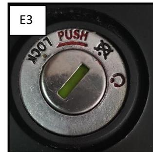
E, Pulsar la llave y girarla hasta la posición de la Figura E2 a Figura E3. Sacar la batería un poco para confirmar que está bloqueada. A continuación, sacar la llave y guardarla.
