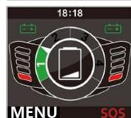
5, Cuando la potencia es menor del 10%, el indicador de batería está en rojo e indica que no se puede avanzar, la potencia es demasiado baja y la silla se parará automáticamente en pocos minutos.
