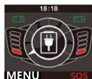
3, Usar la pantalla LCD para ver la situación actual de carga. Cuando enchufe el cargador, la pantalla LCD indicará que la batería se está cargando y el indicador parpadeará. Está prohibido mover la silla de ruedas.
