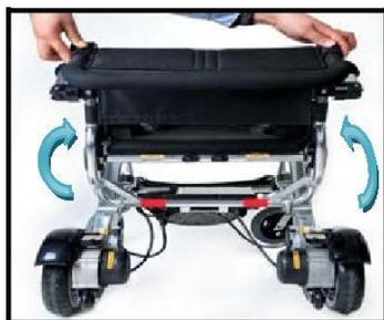
5. Como se indica en la Fig. F5, presionar el botón de ajuste del respaldo y girarlo en la dirección indicada en la figura hasta que se escuche un claro clic.
