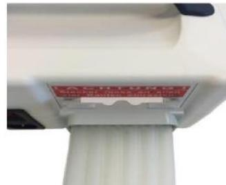
Para poner en funcionamiento el aparato, conecte el cargador a la conexión eléctrica adecuada (Figura 1) e introducir el enchufe en la toma de corriente. Conectar la unidad de control y manguitos a los tubos de conexión. Debido a su diseño los enchufes solamente pueden introducirse en una dirección. (Fig.2 y Fig.3)
